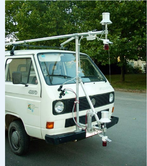
Klimamesswagen der Thüringer Landesanstalt für Umwelt und Geologie (TLUG)
